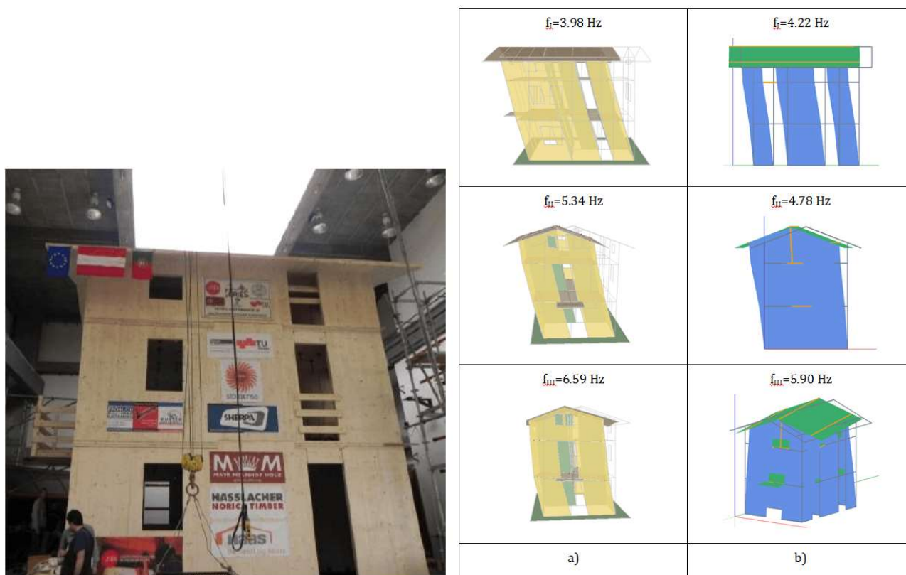
Fig. 5 -6 – Prove sperimentali di simulazione sismica su modelli di edifici in XLAM
