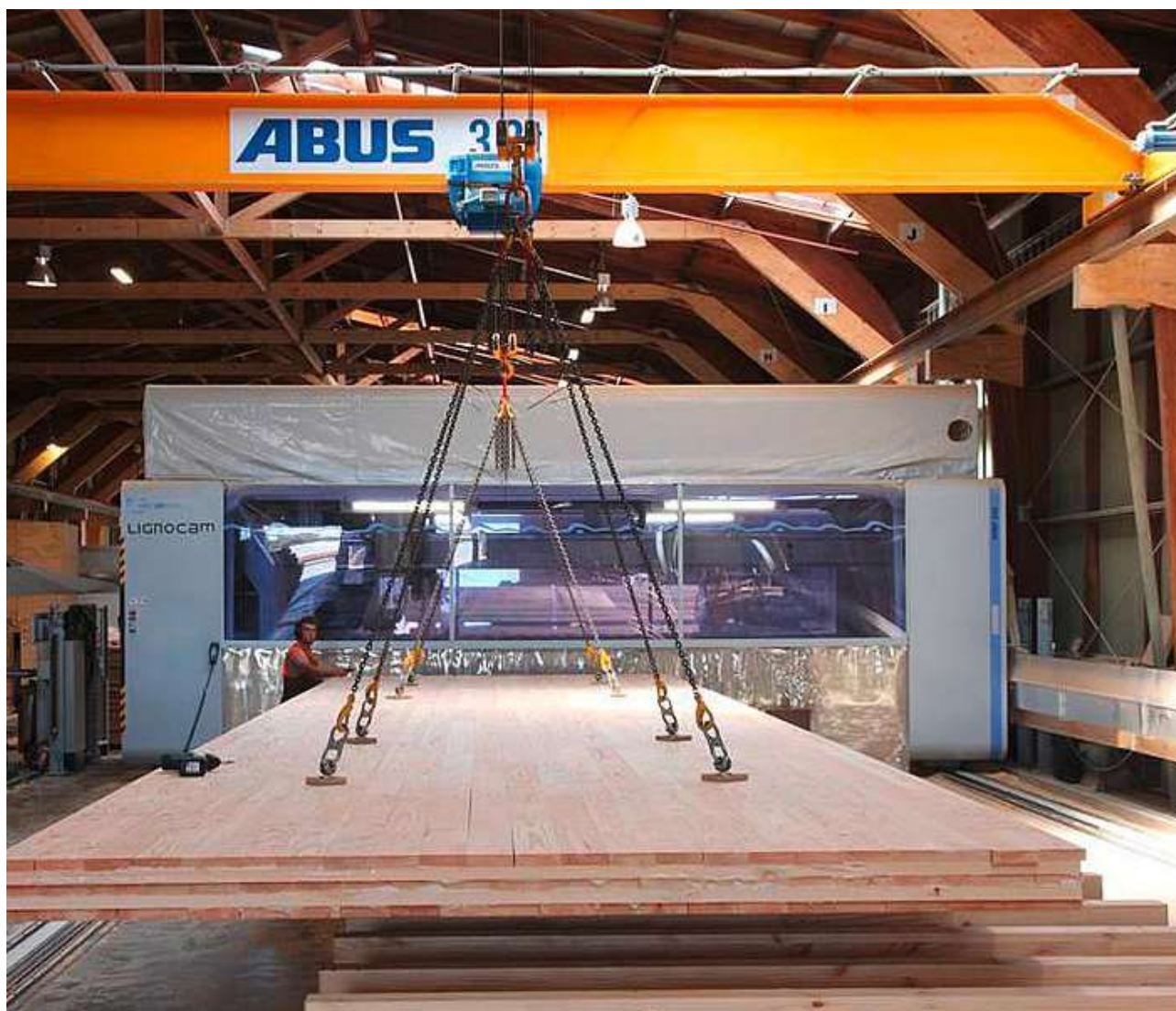
Fig. 2 – Produzione di pannelli in XLAM in stabilimento
